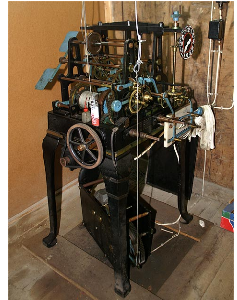
Foto 2008 A. Heymann Die Turmuhr wurde 1955 hergestellt (Fa. Korfhage). Sie steuert den Halbstunden- und Stundenschlag Läuten zum Gottesdienst und das Scheideläuten sind noch echte Handarbeit!
